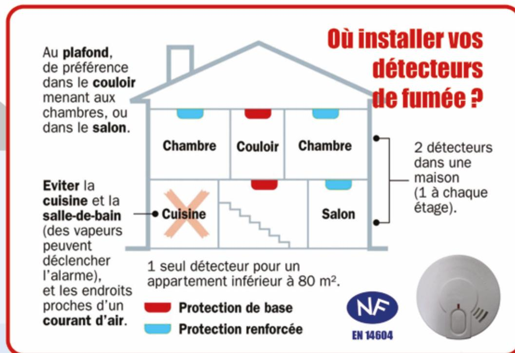
**Installer un détecteur de fumée est simple et à la portée de tous. Il suffit de 2 vis et d'un tournevis.**
